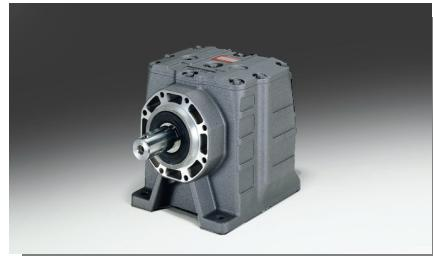
La serie dei riduttori a ingranaggi tipo RD, costruita con carcassa fusa in unico pezzo e con supporto interno per alloggiare 2 o 3 coppie di ingranaggi, è costruita secondo le norme di progettazione ISO e con l'ausilio di programma di analisi strutturale per verifica della deformata e dello stress.
